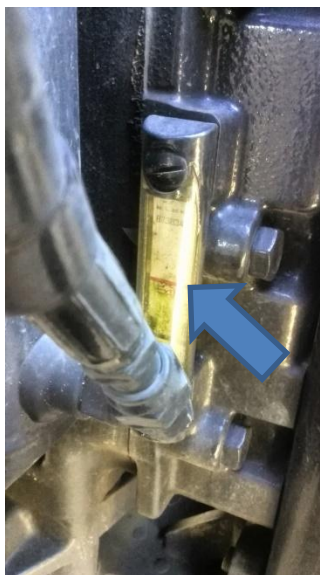
Niveau controle hydroliekolie
